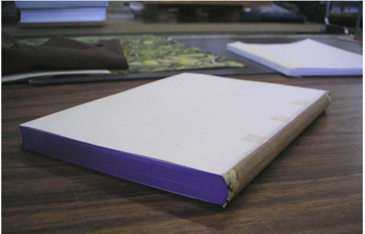
Fertiger Buchblock mit violetter Farbschnitt und handgefertigten Kapitalen. Der Buchrücken ist hier gerundet und abgeleimt worden.
