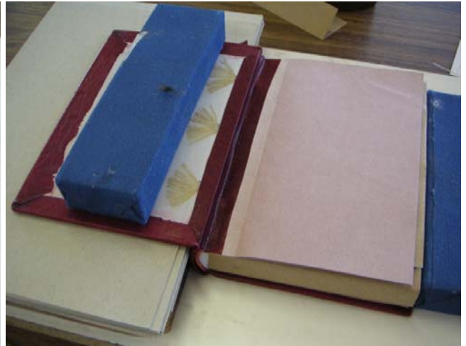
Einsetzen der Lederfälze
