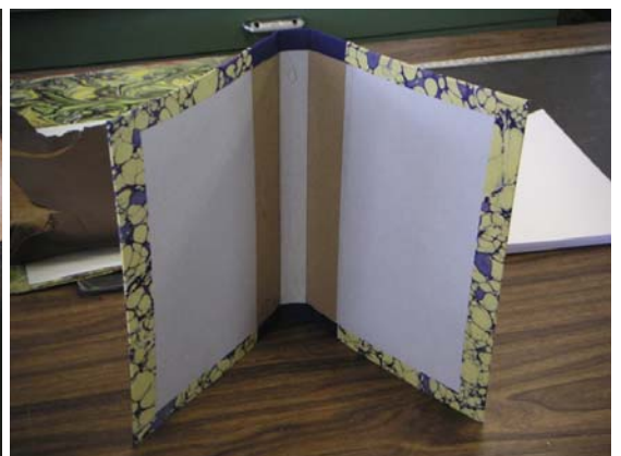
Korrekt verarbeiteter Buchdeckel für Halbgewebeband (Innenansicht)
