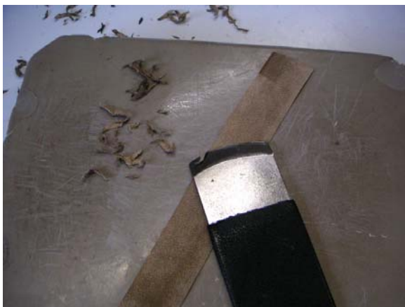
Schärfen von Leder (hier für Lederkantenschoner) von Hand
